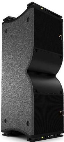
Система K3 работает в диапазоне от 20 кГц до 42 Гц и имеет такой же низкочастотный контур, как K1 и K2, поскольку в конструкции использованы два 12-дюймовых громкоговорителя высокой мощности. Таким образом, систему K3 можно использовать без сабвуферов.
