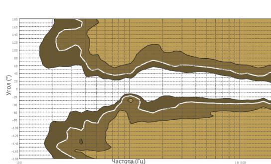
► Диаграмма углов раскрытия одной системы A10 Focus (слева) и A10 Wide (справа) показана в горизонтальной плоскости с помощью линий одинакового звукового давления на -3 дБ, -6 дБ, -12 дБ.
