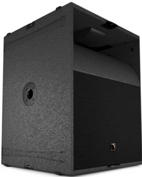
KS21 является компактным эталонным сабвуфером для усиления в низкочастотном диапазоне акустических систем ARCS A15 и A10. В корпусе KS21 с фазоинвертором установлен один длинноходный НЧ громкоговоритель 21” прямого излучения.
